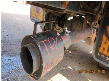
ภาพที่ 2.2-33 รถยนต์ของบริษัทผู้รับเหมาได้ติดตั้งอุปกรณ์ป้องกันประกายไฟ
