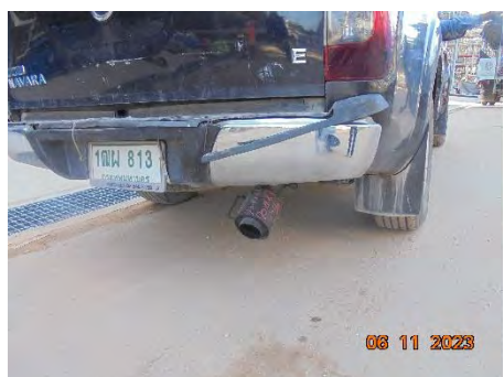
ภาพที่ 2.2-33 รถยนต์ของบริษัทผู้รับเหมาได้ติดตั้งอุปกรณ์ป้องกันประกายไฟ
